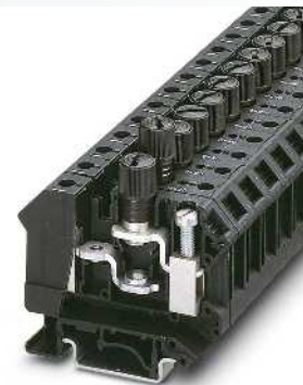
16 (16) мм 2 , 10 А, клемма предохранителя для стеклянных предохранителей 5 x 20 мм
