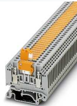
2,5 (4) мм 2 , 16 А, клемма с ножевым размыкателем
