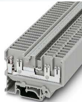
4 (4) мм 2 , 29 А, проходной блок зажимов, с винтовыми и плоскими контактами
