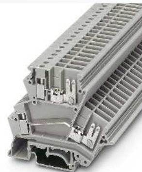
4 (4) мм 2 , 20 А, двухъярусная клемма с винтовым и плоским штекерным подключением
